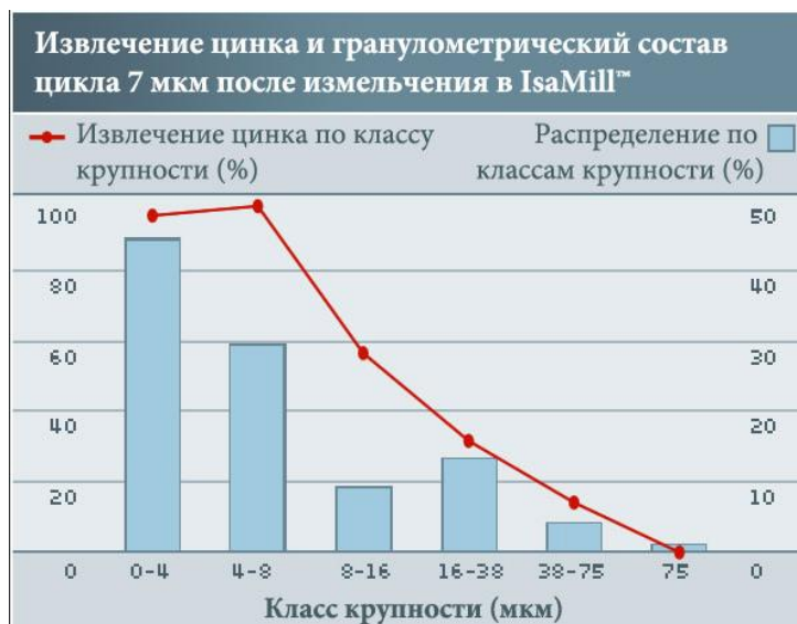
Рисунок 2. Извлечение цинка и гранулометрический состав цикла 7 мкм после измельчения в IsaMill
