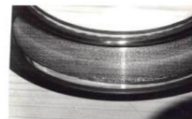
Точечная коррозия на дорожке качения
