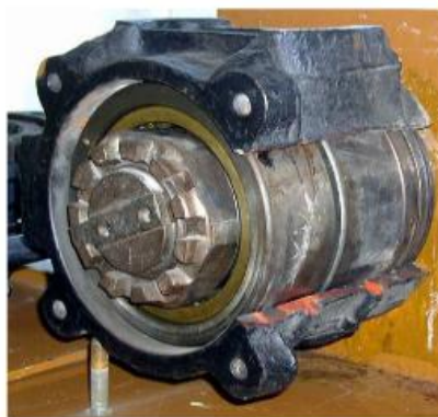
Рисунок 1. Расположение буксы со снятыми крышками и разрезанным корпусом
