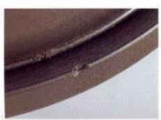
Контактно-усталостное повреждение (раковина) на дорожке качения
