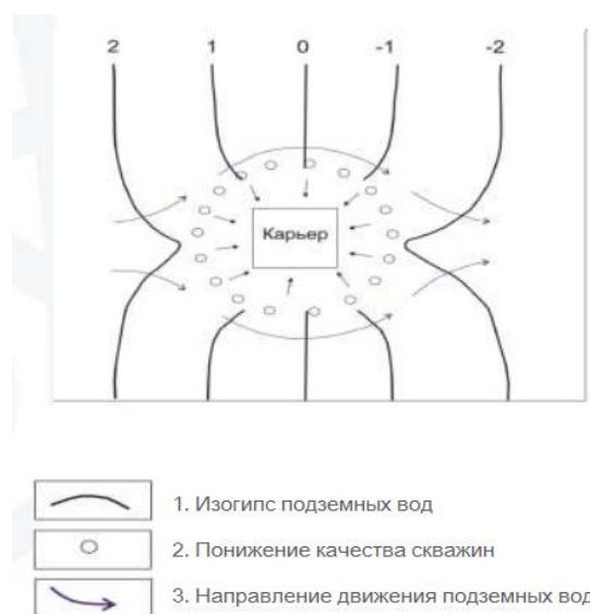
Рисунок 2. Схема расположения скважин и уровней грунтовых вод
