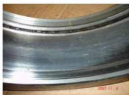
Контактно-усталостное повреждение на дорожке качения
