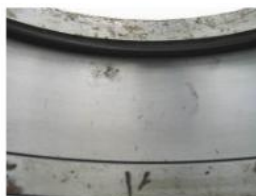
Коррозионные пятна на дорожке качения
