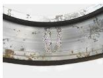
Контактно-усталостное повреждение (раковина) на дорожке качения
