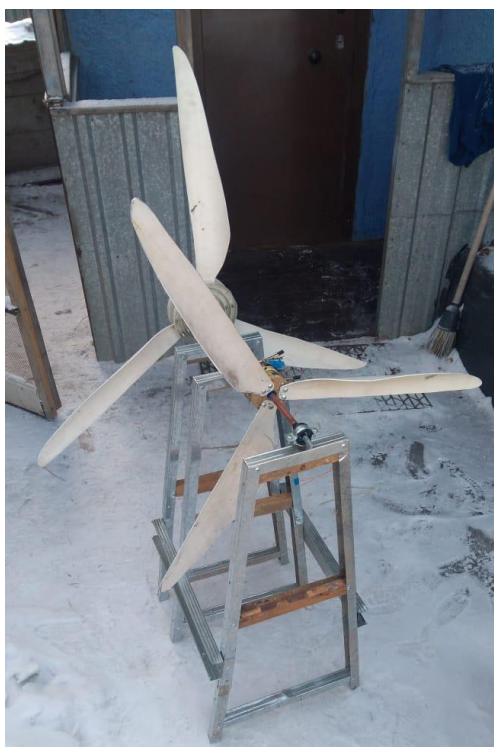
Рисунок 3. Физическая модель взаимодействия ветрового потока с ветротурбинами
