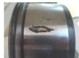
Вмятины (намины) на дорожке качения
