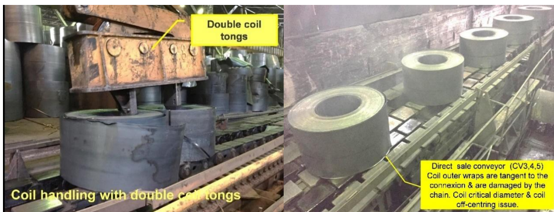
Рисунок 1. Пример работы вертикальной оси транспортировки рулонов
