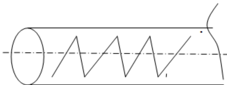
Рисунок 1. Труба со шнеком для смешивания шламов с известьсодержащими материалами
