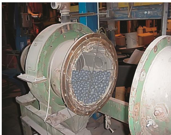
Рисунок 1. Исследование процессов в шаровой мельнице с помощью трёхкомпонентного радиоакселерометра
