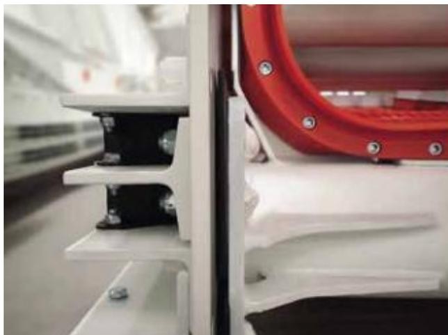
Рисунок 11. Резиновые элементы, связывающие раму с подвижными балками и корпус грохота
