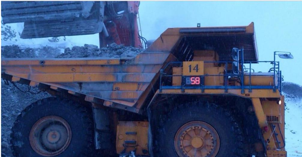
Рисунок 1. Внешний вид автомобиля БЕЛАЗ-75131с цифровым индикаторным табло
