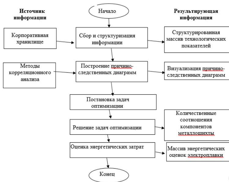
Рисунок 1. Алгоритм выбора соотношения составляющих шихтовых материалов
