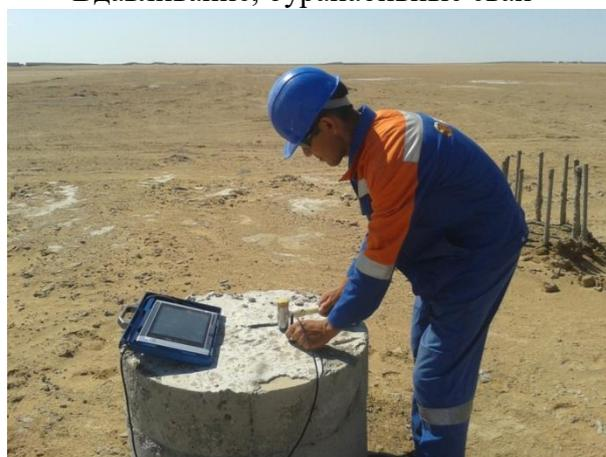
Испытания сплошности сваи
