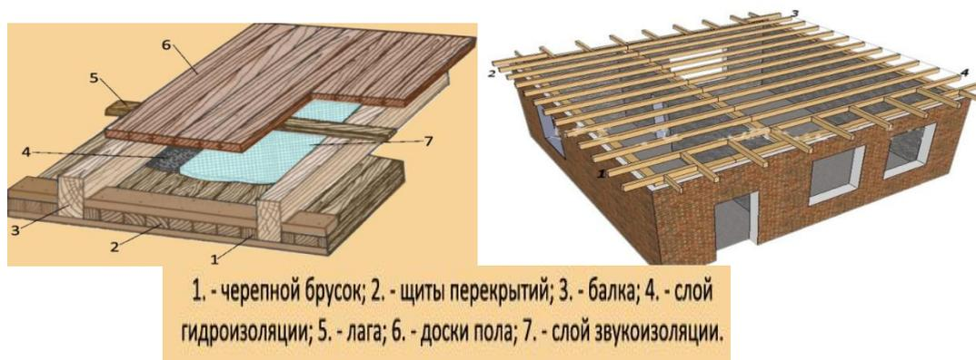
1. - черепной брусок; 2. - щиты перекрытий; 3. - балка; 4. - слой гидроизоляции; 5. - лага; 6. - доски пола; 7. - слой звукоизоляции.
