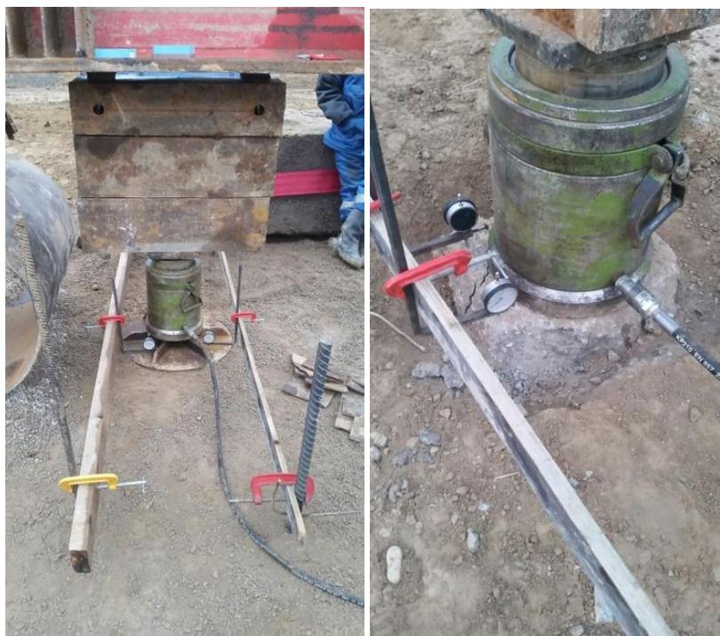
Фото 2. Испытания вертикальных армирующих элементов: а) штампом; б) как одиночной сваи.
