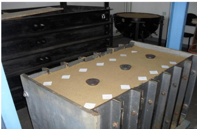
Рисунок 1. Модели фундаментов перед испытанием.
