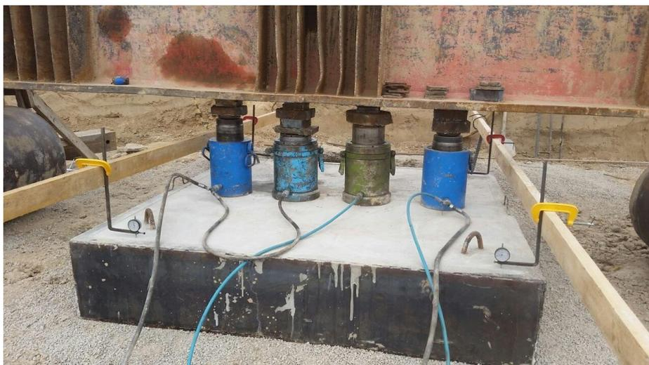
Фото 3. Испытание опытного фундамента с усиленным основанием вертикальными армирующими элементами.
