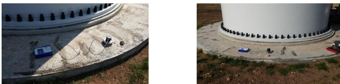
Рисунок 1. Фиксирование вибродатчика на фундаменте ВЭУ.
