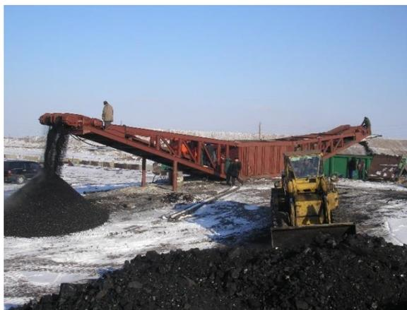
Рисунок 1. Конструкция комплекса ДСКА производительностью 750 т/час в варианте поставки ООО «Каражыра» (Республика Казахстан).
