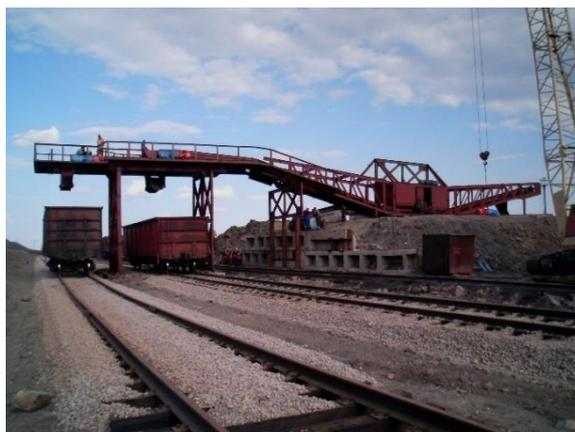
Рисунок 2. Конструкция комплекса ДСКА производительностью 1000 т/час в варианте поставки ОАО «ШубаркольКомир» (Республика Казахстан).
