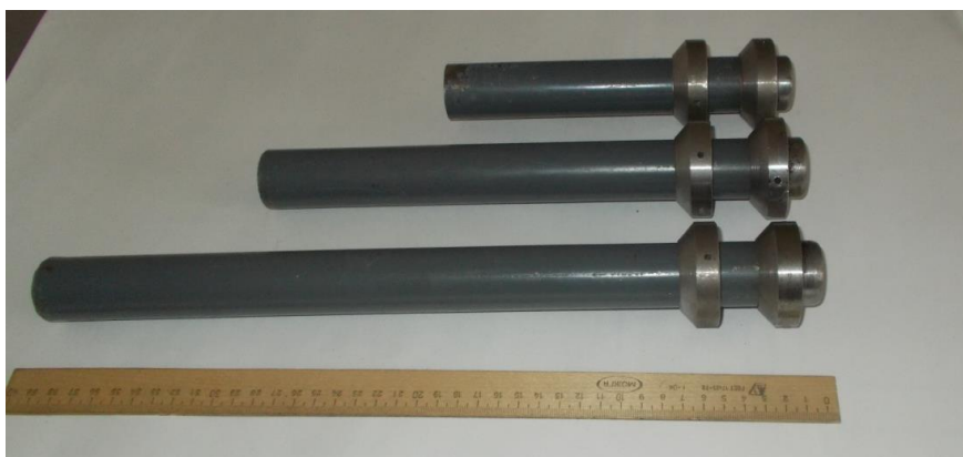
Рисунок 1. Модели буронабивных свайных фундаментов с двумя выступами, исследуемых в лабораторных исследованиях.
