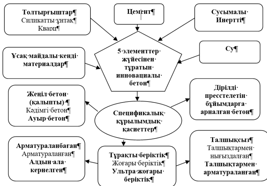
Сурет 1. 5 элементтер жүйесінен тұратын беріктігі ультра жоғары инновациялы бетонның сұлбасы.
