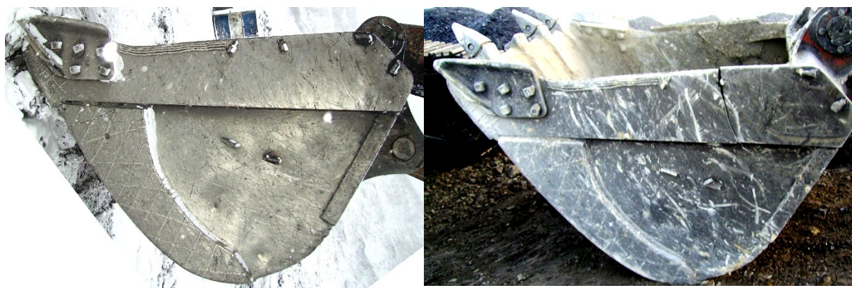
Рис. 2. Ковш экскаватора HITACHI zaxis 600 LC до поломки (слева) и после (справа)
