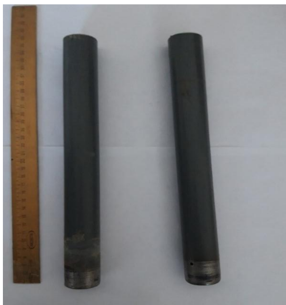
2 – сурет. Зертханалық зерттеулерде қолданылатын классикалық бұрғылау қадаларының модельдері
