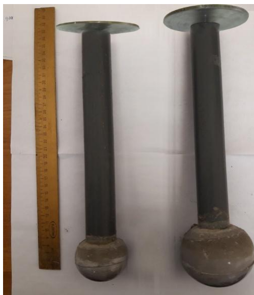
3-сурет. Сынақ алдында зертханалық зерттеулерде қолданылатын камуфлетті қадалардың іргетастарының модельдері
